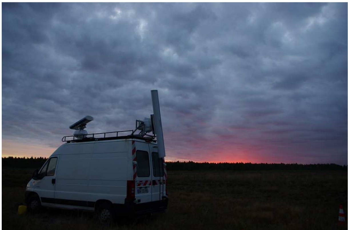
Figure 4. Le radar horizontal est toujours positionné face au Nord. Le radar vertical coupe l'axe Nord-Sud à la perpendiculaire.
