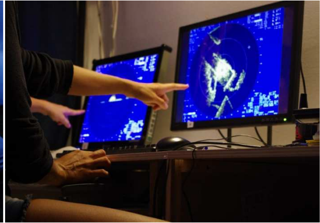
Figure 3. Un écran est relié au radar horizontal et l'autre au radar vertical.
