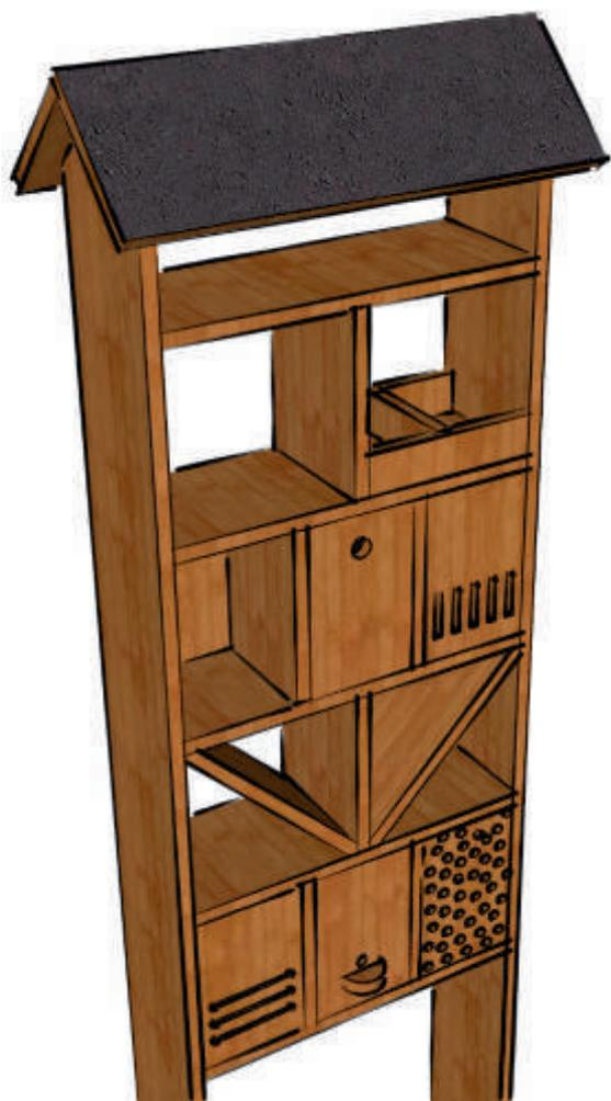
On peut enfin fixer le toit à double pan. Un revêtement imperméable, type toile bitumineuse, est recommandé.
